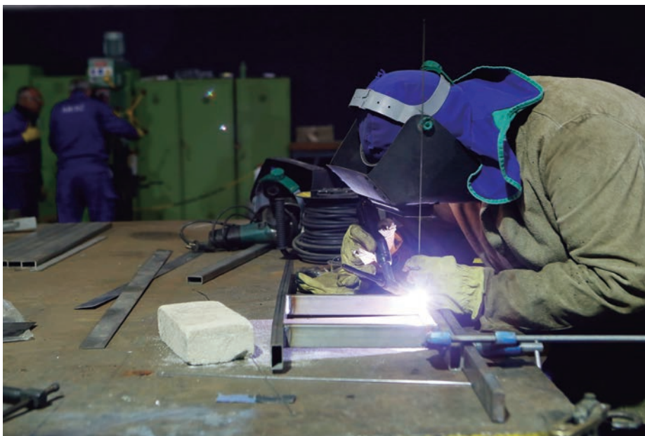
Trabajos de soldadura en el taller de Casco y Máquinas, uno de los diferentes ramos que conforman las instalaciones del arsenal.
