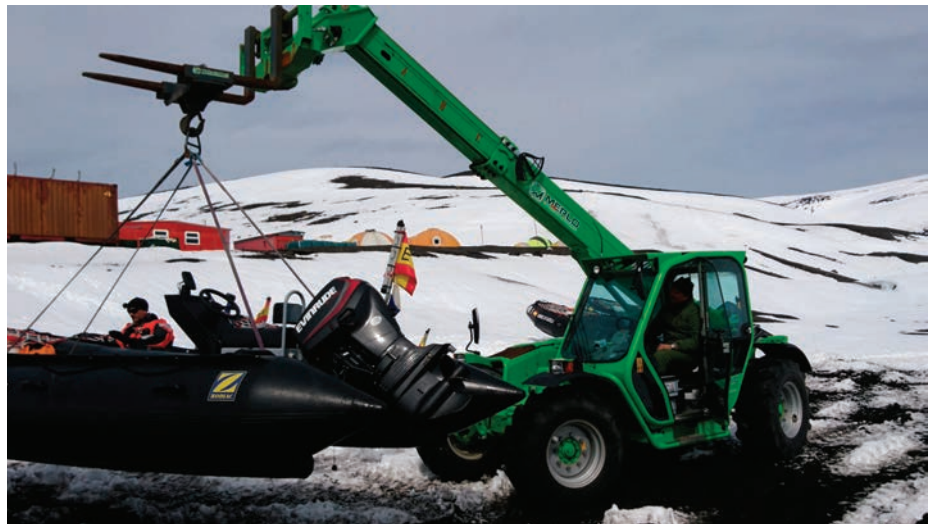
Una carretilla elevadora telescópica saca del agua una de las embarcaciones zodiac con las que militares y científicos se mueven por la isla para sus investigaciones.
