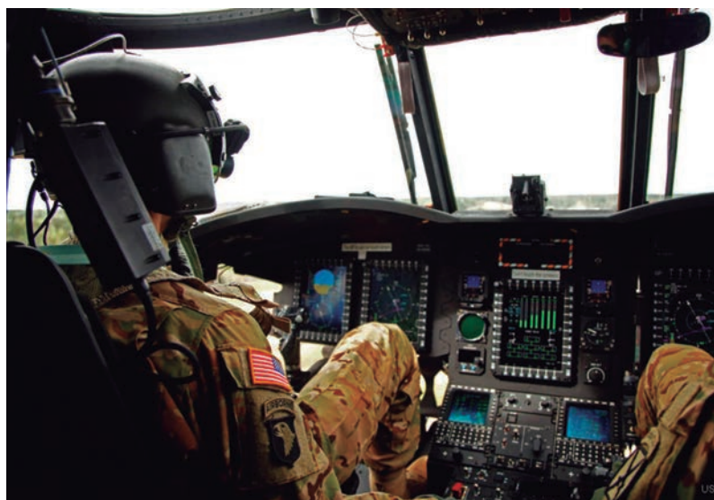
La cabina de la versión F, totalmente digital, ofrece información a través de cinco pantallas y cuenta con gran número de ayudas a la navegación.
