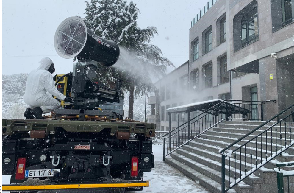
Cañón de nieve que la UME ha adaptado a sus depósitos de desinfectante para facilitar las labores de limpieza.
